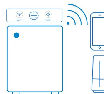
Oczyszczacz powietrza może też być poddany automatycznej regulacji w zależności od odczytów dotyczących jakości powietrza wbudowanych czujników (480i) lub opcjonalnego monitora jakości powietrza na zewnątrz Blueair Aware™ (405).
