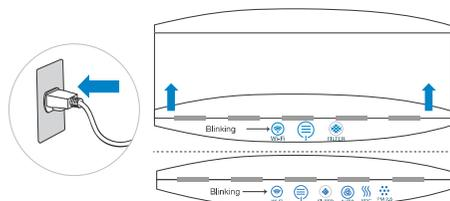
Abra la tapa rebatible y presione el botón táctil de velocidad de flujo de aire. Cuando el símbolo de Wi-Fi comience a parpadear, el purificador de aire se puede sincronizar con la aplicación móvil Blueair Friend.
