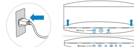
Klappen Sie den Deckel hoch und drücken Sie den Berührungsschalter für die Luftdurchsatzgeschwindigkeit. Wenn das WLAN-Symbol blinkt, kann der Luftreiniger mit der mobilen App Blueair Friend gekoppelt werden.
