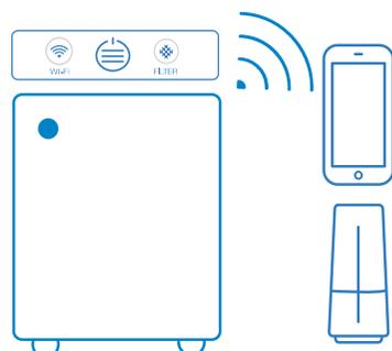
Der Luftreiniger kann auf Basis der Luftgütemessungen der eingebauten Sensoren (480i) oder über den optionalen externen Luftgütemesser Blueair Aware™ (405) auch automatisch geregelt werden.
